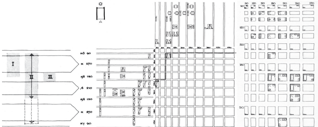
Fig. 9. Comprobación mediante variaciones de la capacidad de las zonas para albergar dormitorios o baños. Habraken, J.N: El diseño de soportes , Barcelona, GG, 2000.
