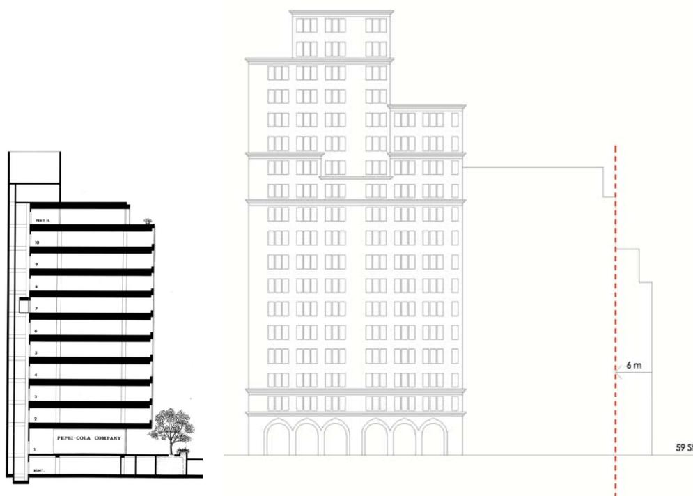
**Figura. 182.** Sección y desplazamiento de la fachada desde la calle 59. (Fuente: *Avery Architectural and Fine Arts Library at Columbia University in New York*) (Gráfico derecha: elaboración propia)
