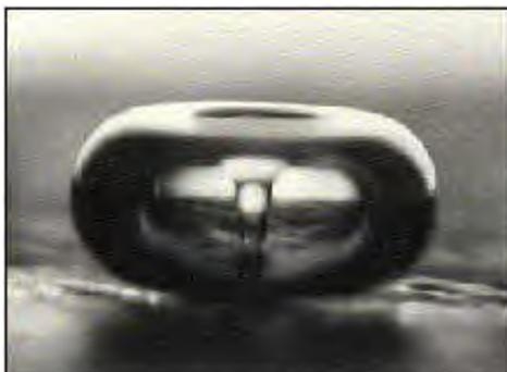
**Imagen 3:** Microjets fotografiado al producirse el colapso de una burbuja de 1 mm
