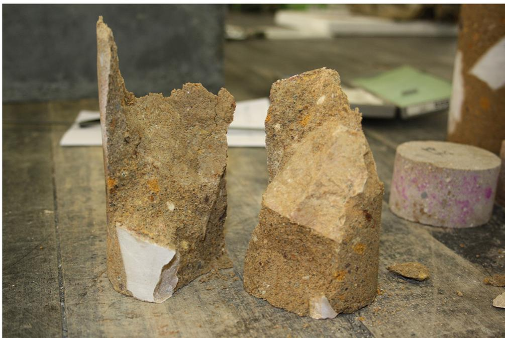
Figura 12. Resultados de los testigos tras los ensayos mecánicos.
