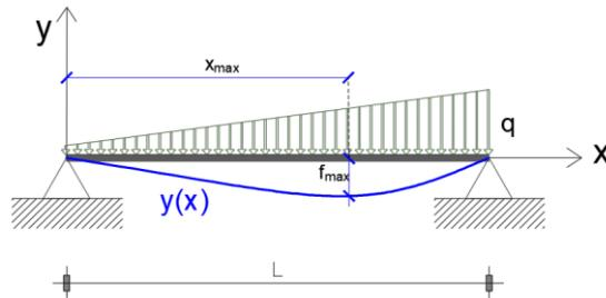
La carga no es simétrica y las funciones  $M(x)$  e  $y(x)$  tampoco lo son. Por ello los puntos de esfuerzo de flexión máxima y flecha máxima no se producen en el centro de la viga. Considerando esto, se pide:
