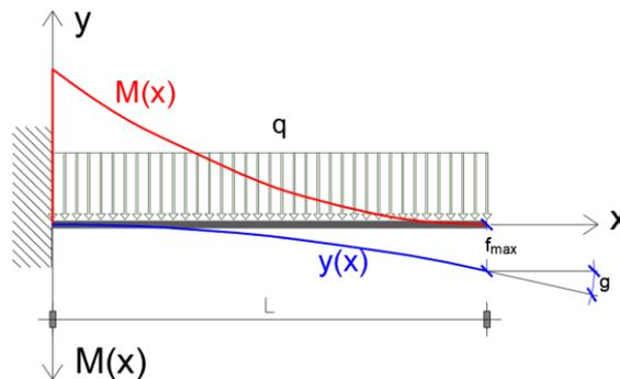
El giro máximo  $g$  se produce en el extremo derecho y su valor se puede calcular como el cociente entre la integral definida de 0 a  $L$  de la función  $M(x)$ , dividida entre la constante  $EI$ .
