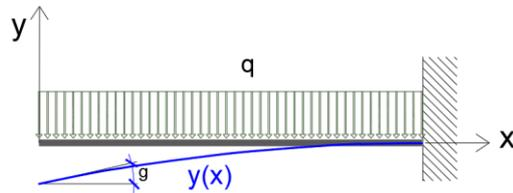
Este giro puede calcularse mediante el cociente entre el área de la parábola  $M(x)$  (calculada en V04 y cambiada de signo) dividido por la constante  $EI$ . Sabiendo esto, se pide:
