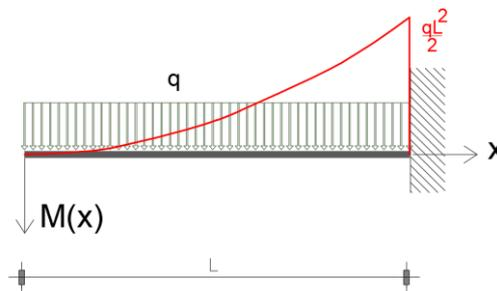
Esa sollicitación interna provoca la deformación elástica indicada y representada por la función  $y(x)$ , con un valor máximo de su flecha  $f$  en el extremo libre.
