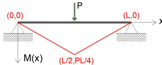
Se aprecia en ella que esta variación es lineal por tramos. En el intervalo izquierdo  $(0, L/2)$   $M(x)$  pasa por los puntos  $(0, 0)$  y  $(L/2, PL/4)$  y en el tramo derecho por los puntos  $(L/2, PL/4)$  y  $(L, 0)$
