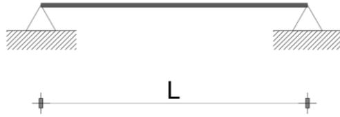
Cuando se carga con una carga vertical puntual  $P$  en su punto medio, en cada una de sus secciones se produce un esfuerzo interno de flexión diferente. En la siguiente figura se representa la función del valor de este esfuerzo  $M(x)$  correspondiente a la sección situada a la distancia  $x$  del origen.
