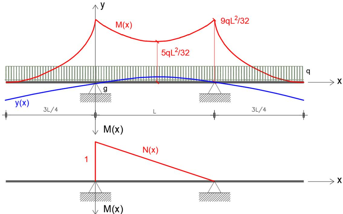
Se pide el valor de dicho giro  $g$ , planteando en este caso la resolución de la integral por el método de Simpson:
