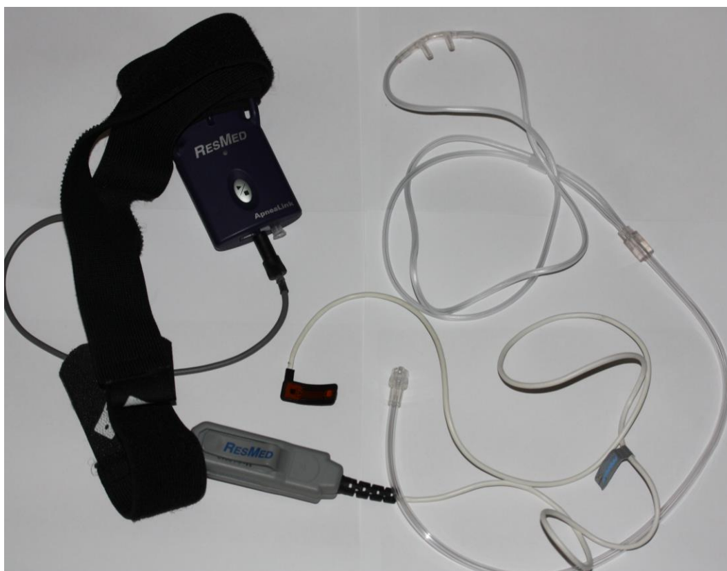
Ilustración 8: Dispositivo portátil tipo IV: ApneaLink ®
