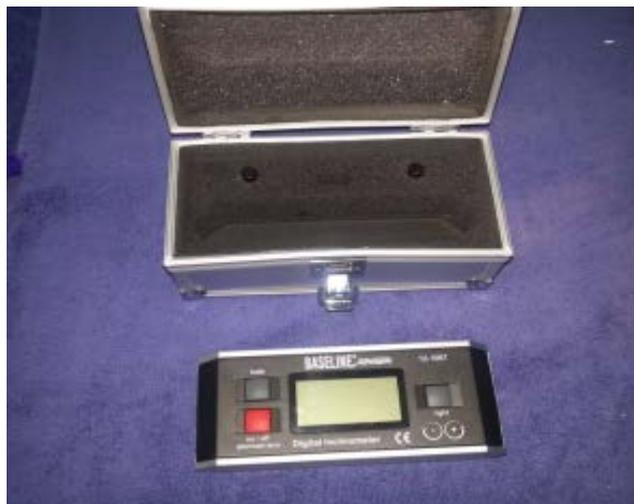
**Figura 8.** Instrumento inclinómetro sin modificación. Inclinómetro digital electrónico (precisión  $\pm 0.5^\circ$ ) de la [Saunders Group, Inc.](#)
