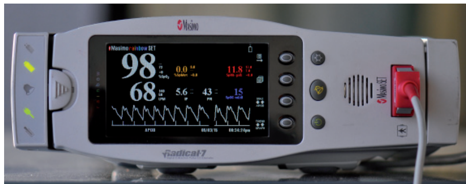
Figura 13. Monitor Radical 7 con la tecnología Masimo Rainbow SET Pulse CO-oximetry . Se aprecia la SpO 2 , frecuencia cardiaca, onda de pulso, índice de perfusión, índice de variabilidad de la onda de pulso, SpMet, contenido arterial de oxígeno y SpHb.
