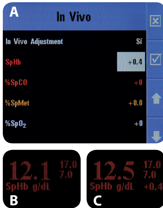
Figura 15. Calibración in vivo . A: Pantalla para la realización de la calibración in vivo del monitor Radical-7, donde se aprecia la introducción de un factor de calibración de +0,4. B: Visualización de SpHb antes de realizar la calibración in vivo . C: Visualización de SpHb tras la calibración in vivo donde se muestra el factor de calibración introducido.
