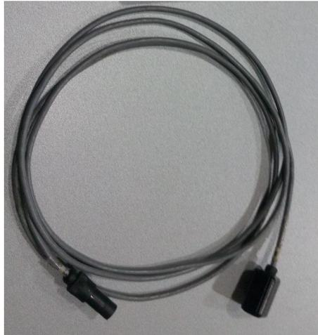
**Figura 21** Acelerómetro para el registro de absorción de impactos
