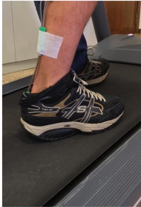
**Figura 26 Electrogoniómetro colocado en tobillo para registro de la marcha en treadmill**
