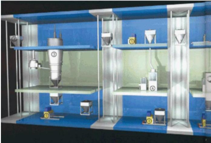
**Figura 6. Las zonas de producción o zonas limpias están localizadas entre dos plantas técnicas. La transferencia de los productos es por gravedad lo que representa ahorro de superficie construida**
