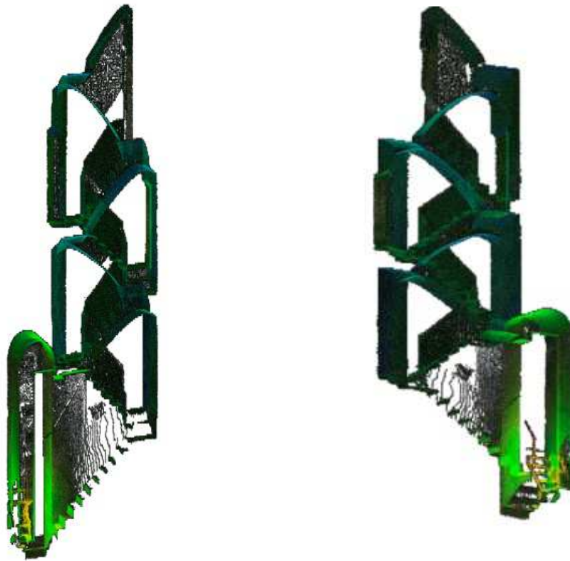
[Fig IV.25.]: Infografía de la escalera obtenida con el escáner láser
