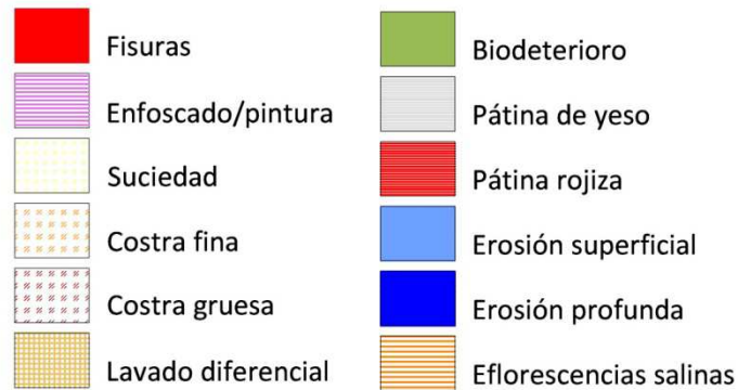
[Fig.V.62.]: Leyenda defectos descritos.
