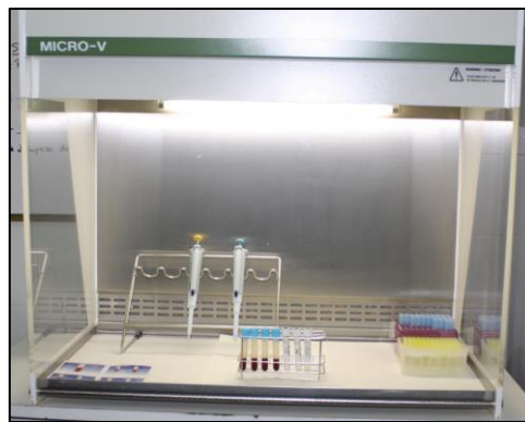
Figura 32. Campana de flujo laminar para el proceso de pipeteo de la fracción plasmática en el aislamiento del PRGF empleando material estéril y respetando estrictamente las normas de asepsia.
