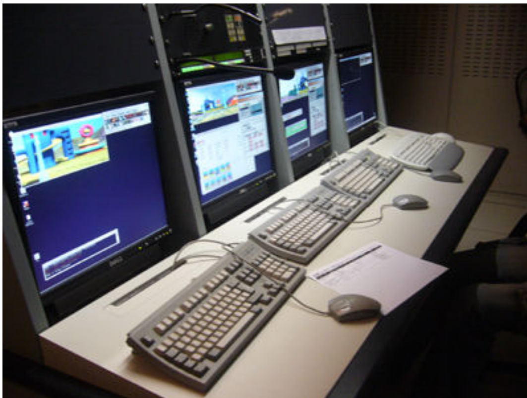
Puesto de operación de Brainstorm en TVE en Sant Cugat del Vallés durante la grabación del programa infantil Los Lunnies . Habitualmente lo ocupan uno o dos operadores en función de la complejidad de cada grabación. Fuente propia.
