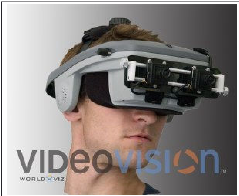
Dispositivo de realidad aumentada video-see-through 48
