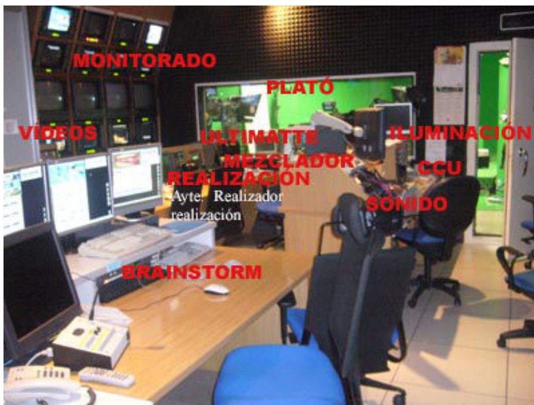
Disposición de los elementos técnicos en el Estudio 4 de escenografía virtual de TVV. Enero de 2007. Fuente propia
