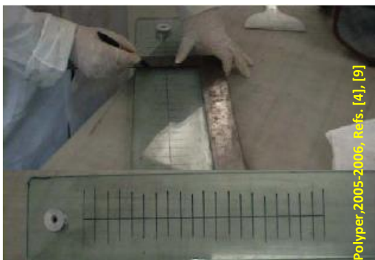
Figura 3.2. Preparación del contra molde con líneas de referencia para registrar el tiempo de llegada del flujo, ante propagaciones unidireccionales (izq.) y Figura 3.3. Molde de caracterización para la medición de permeabilidad (der.) [4], [9].
