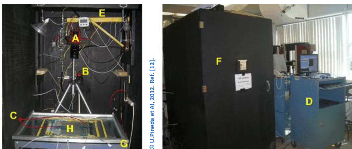
Figura 4.17. (Izq.) Ubicación del molde para la fabricación del composite, el cual es monitorizado mediante una cámara térmica (A), una cámara de espectro visible (B), sensores cero-dimensionales de temperatura – Flujo de calor (C), sensores de temperatura ambiente (E). (Der.), Caja negra cerrada (F), sistema de adquisición por ordenador (D).
