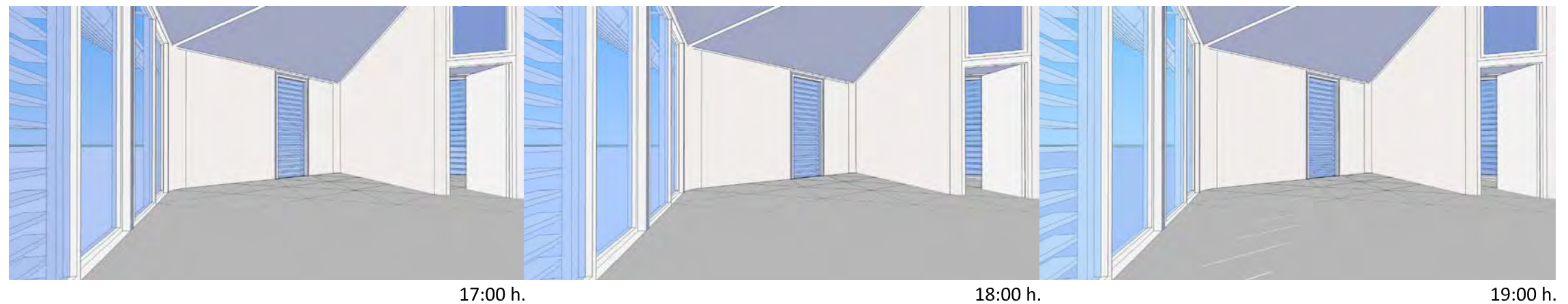
HUECO SUROESTE. Madrid. 21 de Junio. Contraventana de lamas cerrada. Inclinación de lama 20°.
