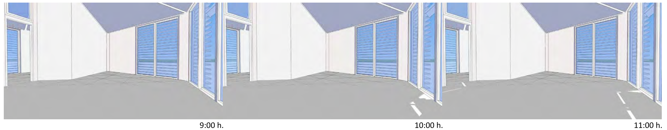
HUECO SUROESTE. Madrid. 21 de Junio. Contraventana de lamas cerrada. Inclinación de lama 20°.
