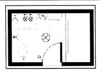
Figura H: Plano de planta del baño-aseo
