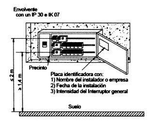
Figura A: Características y ejemplo de instalación del cuadro general de mando y protección en una vivienda.
