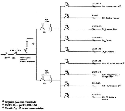
Figura B: Ejemplo de esquema unifilar en vivienda con electrificación básica con circuitos desdoblados.
