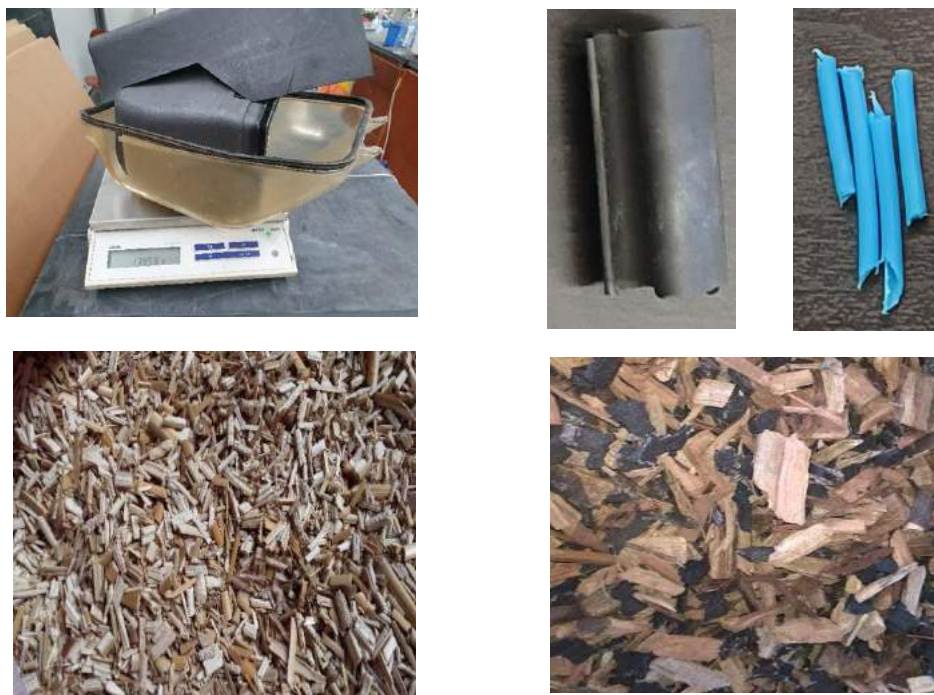
Figura 2. Materias primas utilizadas para la gasificación conjunta en el reactor. (a) residuos de gomas. (b) desechos de cauchos plásticos c) biomasa de miscanto. d) Acacia biomasa. (Fuente: elaboración propia)
