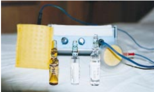
Fig. 4. Aplicador de iontoforesis y viales habituales.
