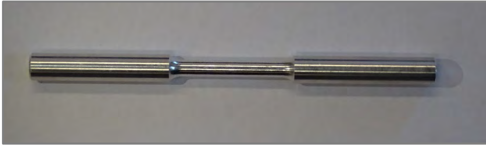
Ilustración 2.- Probeta de tracción según norma ISO 6892-1:2016.
