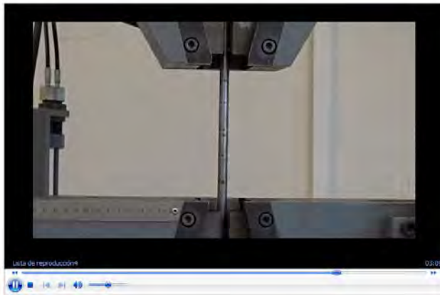
Ilustración 9.- Primeros instantes de estricción de la probeta (189 segundos).
