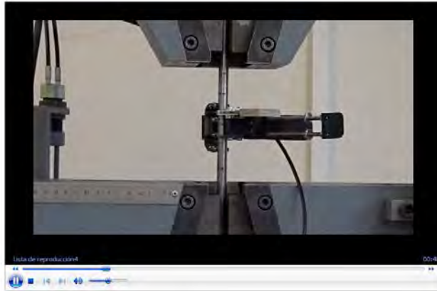
Ilustración 7.- Entrada en la fase de comportamiento plástico de la probeta (48 segundos).
