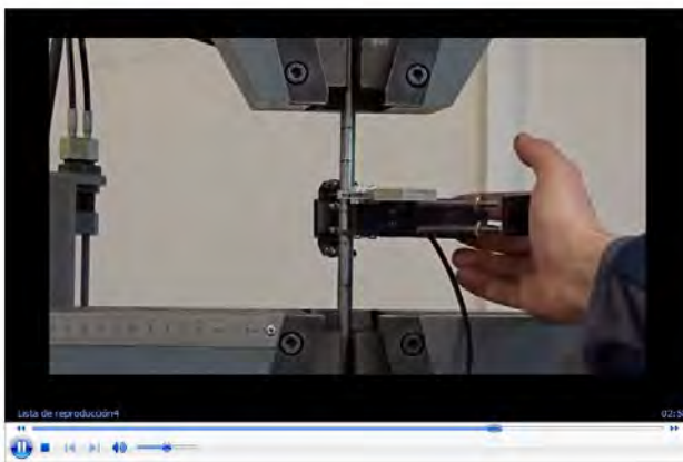
Ilustración 8.- Llegada al punto máximo de la curva de tracción (178 segundos).
