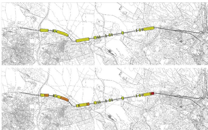
Figura 3.10: Identificación y valoración de la presencia de infraestructuras eléctricas en el paisaje a lo largo de la A-5, sentido entrada a la ciudad (de izquierda a derecha). Arriba: análisis sin valoración. Abajo: Análisis con valoración en tres categorías: alta (rojo), media (naranja) y baja (amarillo).
