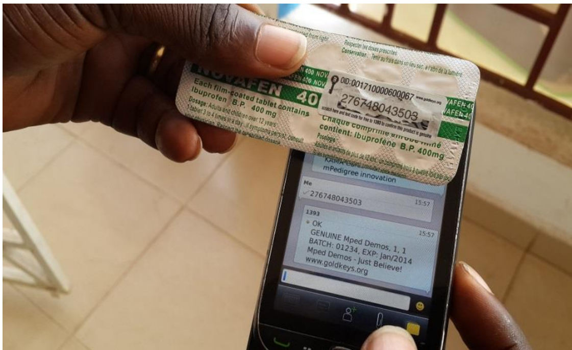
Fig.73. Sistema de un código rascable que permite detectar los medicamentos falsos.
