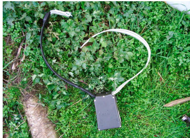
Figura 2. Detalle del collar GPS-GPRS.
