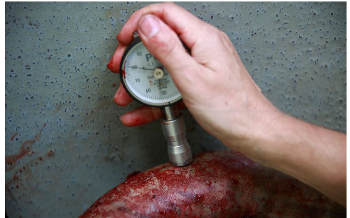
FIGURA 5: Midiendo la dureza superficial en la pala
