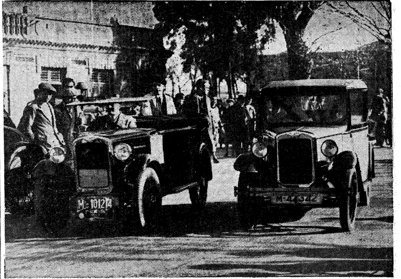
Prueba de consumo organizada por el Moto Club, en la que resultaron ganadores los "AUSTIN". En primer puesto, el "7 HP.", que consumió 4,925 litros por 100 kilómetros, y, en segundo, el "9 HP.", con 5,50 litros por 100 kilómetros.
